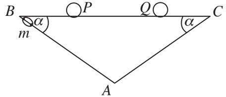
අනතුරුව ඇතිවන චලිතයේදී රාමුවේ ත්වරණයේ විශාලත්වය  $\frac{mg \sin 2\alpha}{2(M + m \sin^2 \alpha)}$  බව පෙන්වා, පබළුව මත ප්‍රතික්‍රියාව  $\frac{Mmg \cos \alpha}{M + m \sin^2 \alpha}$  බව ද පෙන්වන්න.
