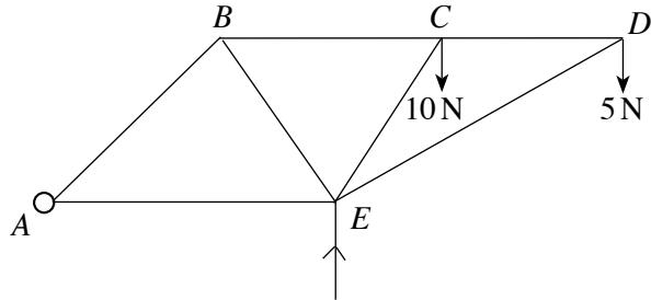
ஏழு இலோசன கோல்களை ஒப்பமாக இணைப்பதன்மூலம் சட்டப்படல்  $ABCDE$  அமைக்கப்பட்டுள்ளது. அதில்  $AB = AE = BE = BC = CE = CD$  ஆகும்.  $A$  இல் சுயாதீனமாகப் பிணைக்கப்பட்டிருக்கும் இச்சட்டப்படல்  $AE$  உம்  $BCD$  உம் கிடையாக இருக்குமாறு  $E$  இல் பிரயோகிக்கப்படும் ஒரு நிலைக்குத்து விசையின் மூலம் ஒரு நிலைக்குத்துத் தளத்திலே நாப்பத்தில் உள்ளது.  $D, C$  ஆகிய மூட்டுகளில் முறையே 5 N, 10N சுமைகள் தொங்கவிடப்பட்டுள்ளன.
